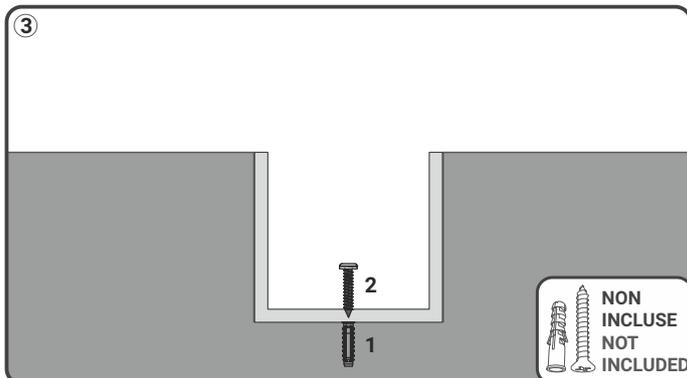
1) Forare e inserire i fisher nel cemento seguendo l'interasse dei fori in base alla lunghezza del profilo.
